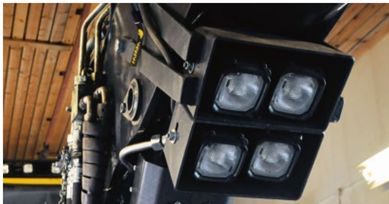
Bengt-Ola Börjesson har bland annat låtit flytta delar av arbetsbelysningen och förstärkt såglådan på aggregatet för att förbättra produktiviteten och hållbarheten.
